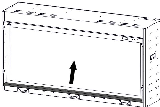
3. Retirez les supports de fixation en haut du verre. Tirez le verre vers l'extérieur en utilisant la ventouse fournie. Alternativement, retournez les fixations de sécurité et accrochez le haut du verre pour le tirer vers l'extérieur.
