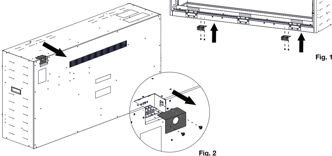
5. Une fois les supports installés, faites appel à deux personnes pour soulever l'appareil et l'insérer dans l'encadrement brut.
