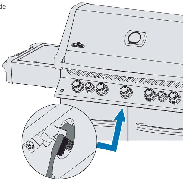
**ATTENTION!** Il est très important que la valve / l'orifice pénètre dans le tube du brûleur lors de la réinstallation du brûleur après nettoyage et avant d'allumer votre grill à gaz, sinon un incendie ou une explosion pourrait se produire.
