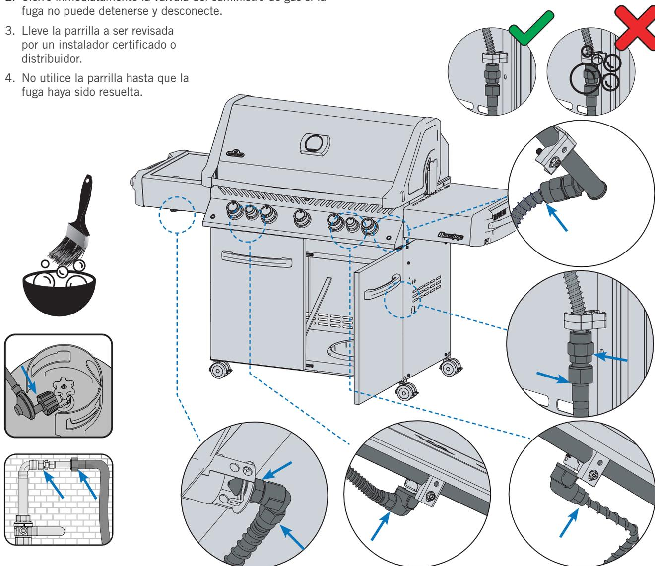
**¡ADVERTENCIA!** Nunca use una flama abierta para detectar fugas. El fuego abierto o una chispa puede ocasionar un incendio o explosión.
