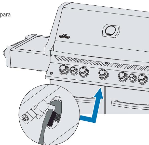
**¡ADVERTENCIA!** Es de suma importancia que la válvula que regula el flujo de gas se introduzca correctamente en el cilindro del quemador al reinstalarlo en la parrilla. Una re-instalación incorrecta puede ocasionar un incendio o explosión.
