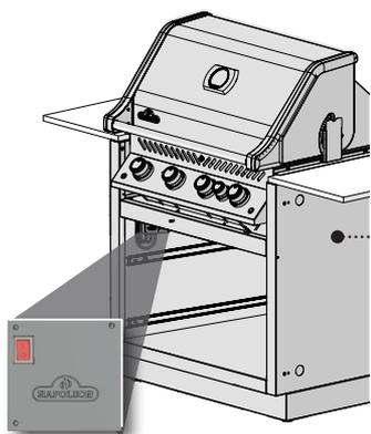
Allumez l'interrupteur d'alimentation situé sur le boîtier de commande.
