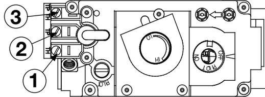
Déconnectez les fils des bornes 1 et 3 du soupape (de l'interrupteur marche/arrêt) et remplacez-les par les fils de l'interrupteur mural/thermostat millivolt.
