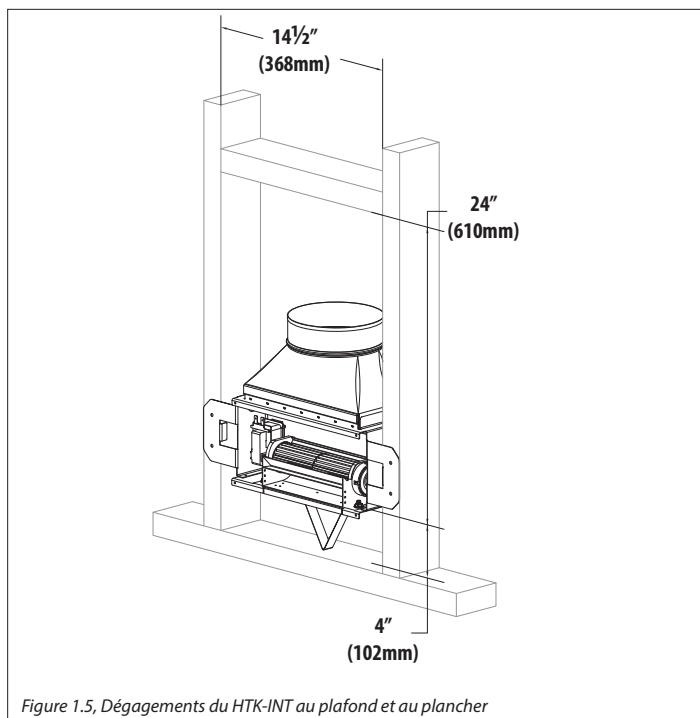
Figure 1.5, Dégagements du HTK-INT au plafond et au plancher
