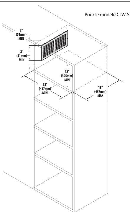
Figure 1.11, Dimensions d'installation avec étagère pour modèle CLW-ST
