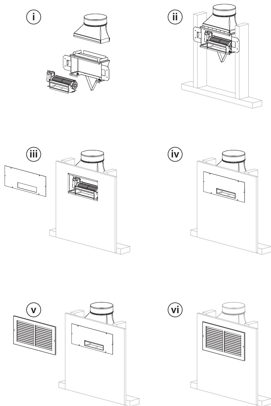
Figure 2.5, Installation du ventilateur
