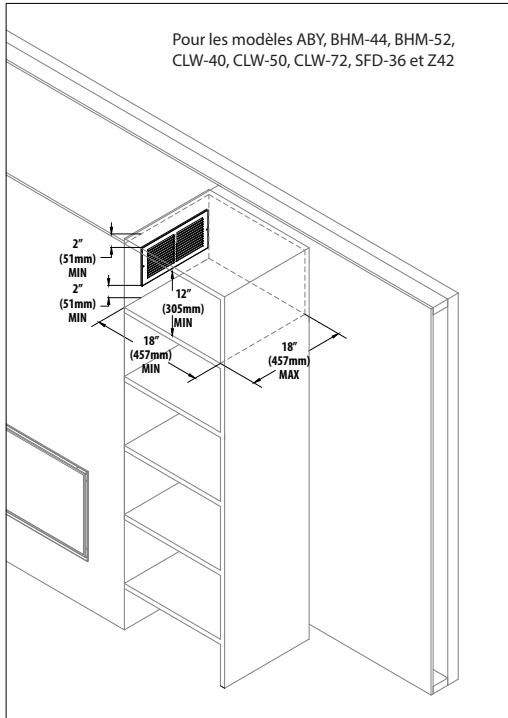
Figure 1.9, Dimensions d'installation avec étagère pour modèles ABY, BHM-44, BHM-52, CLW-40, CLW-50, CLW-72, SFD-36 et Z42
