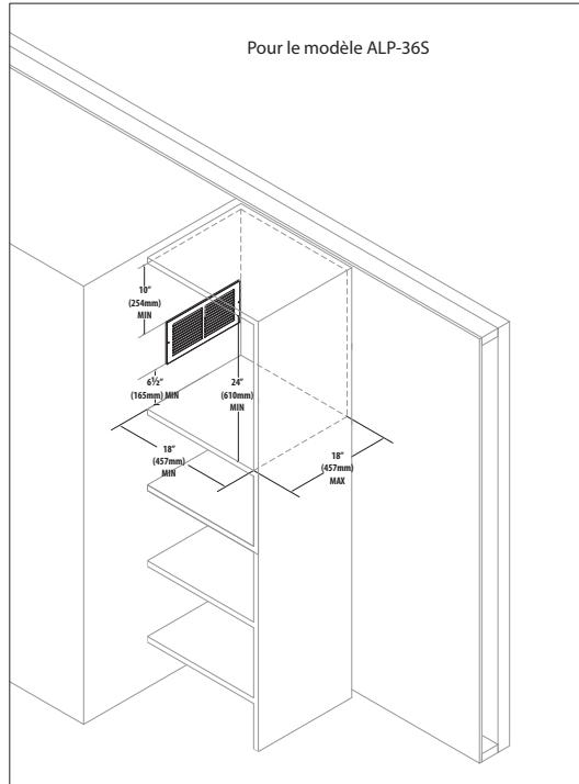
Figure 1.10, Dimensions d'installation avec étagère pour modèle ALP-36S
