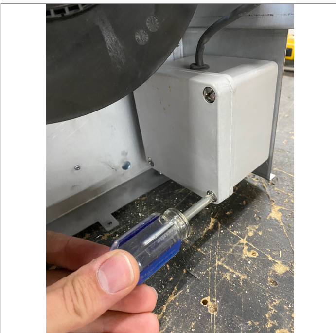
Figure 4.2, Retrait du couvercle du boîtier électrique
