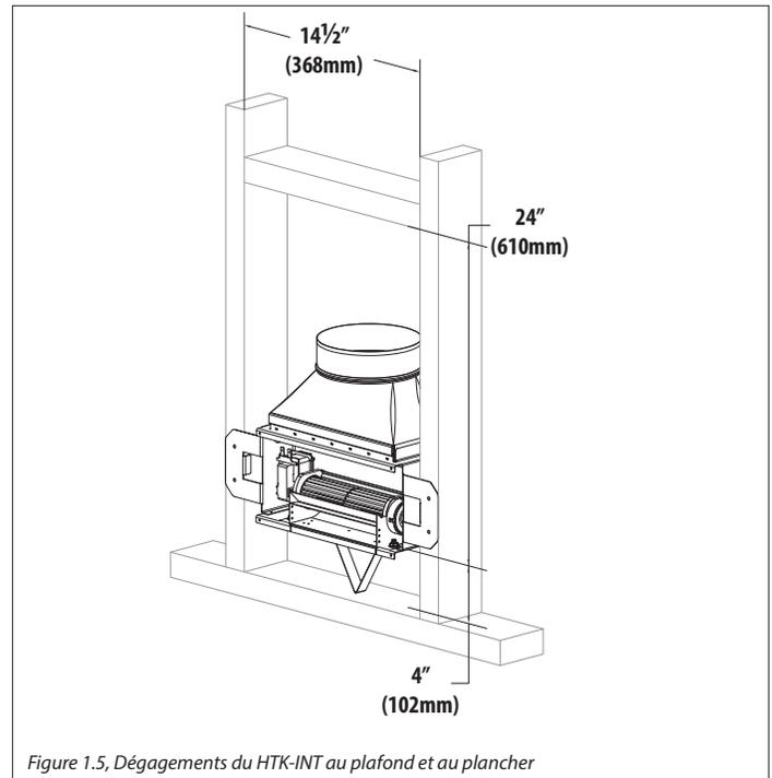
Figure 1.5, Dégagements du HTK-INT au plafond et au plancher
