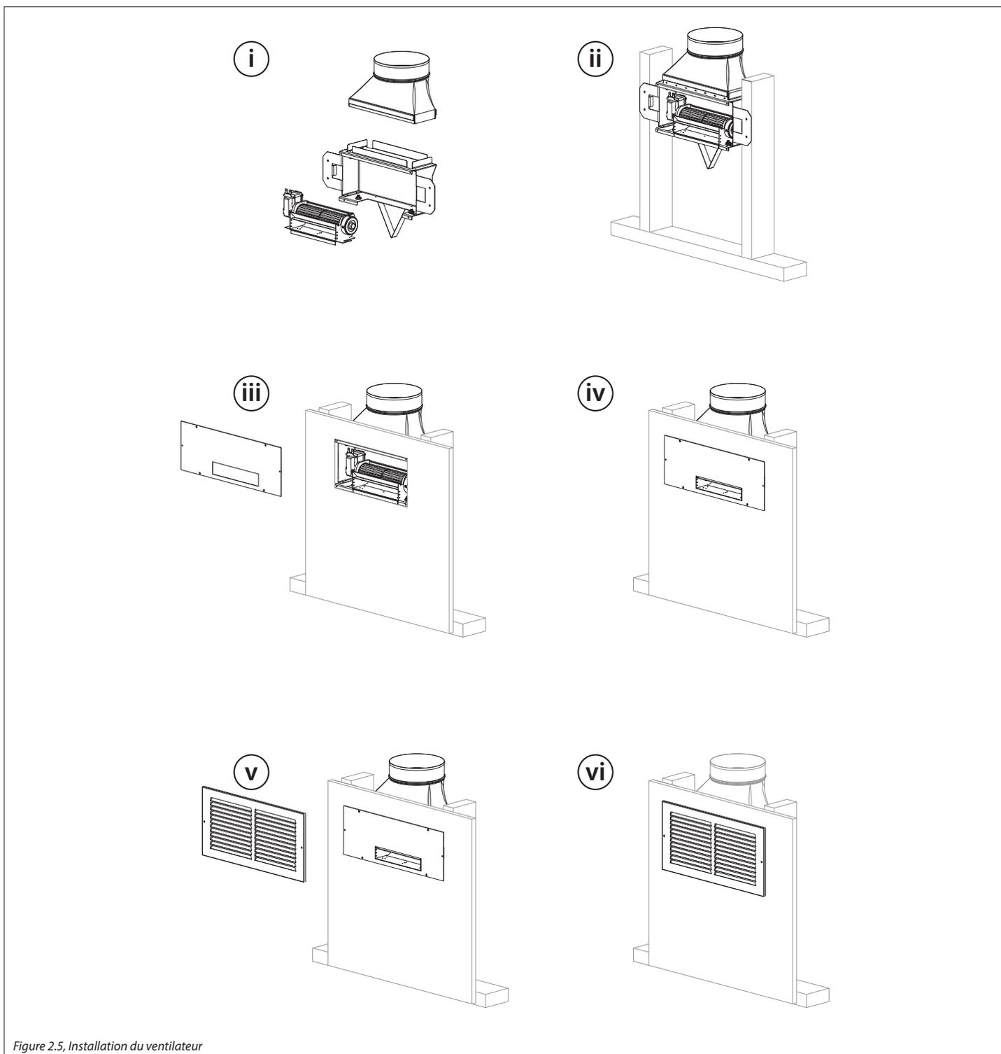
Figure 2.5, Installation du ventilateur
