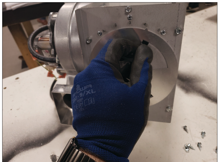
Figure 2.9, Ajustement de la dérivation de tirage
