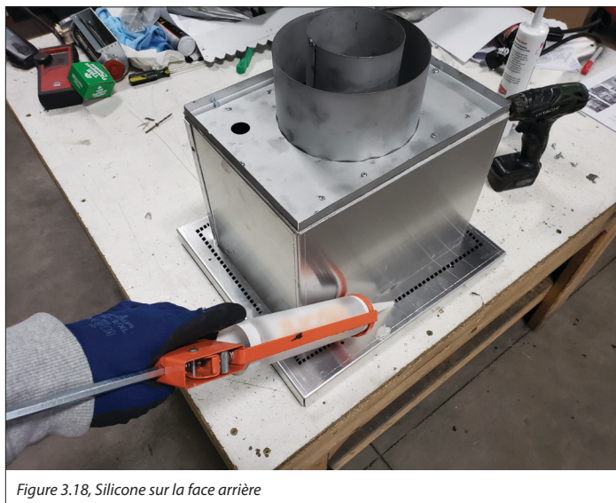
Figure 3.17, Calfeutrage au silicone résistant aux intempéries
