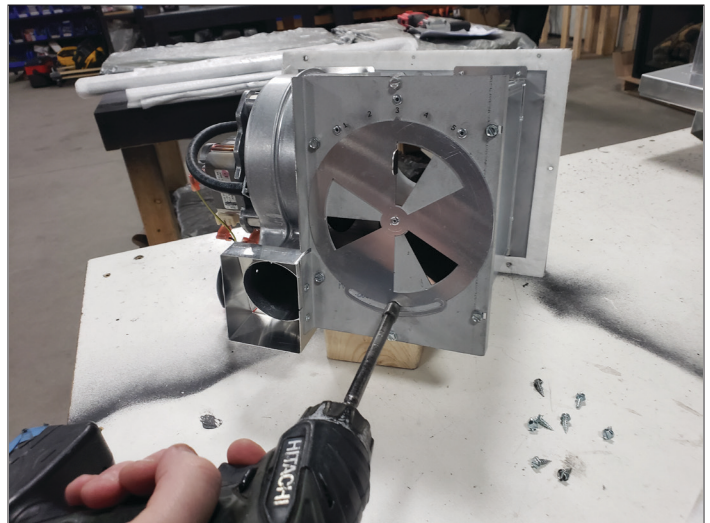
Figure 2.8, Desserrage de la vis de blocage
