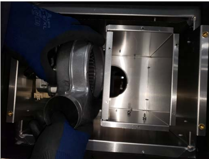
Figure 5.7, Retrait du ventilateur
