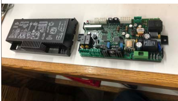
Figure 4.1, Retrait du couvercle du panneau de contrôle
