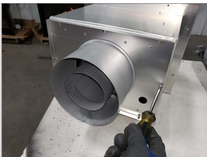
Figure 3.6, Retrait de l'assemblage arrière du chapeau
