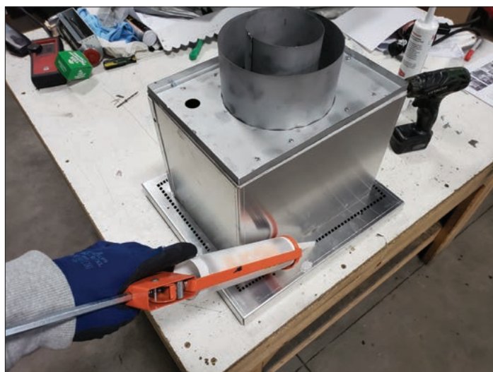
Figure 3.19, Silicone sur la face arrière
