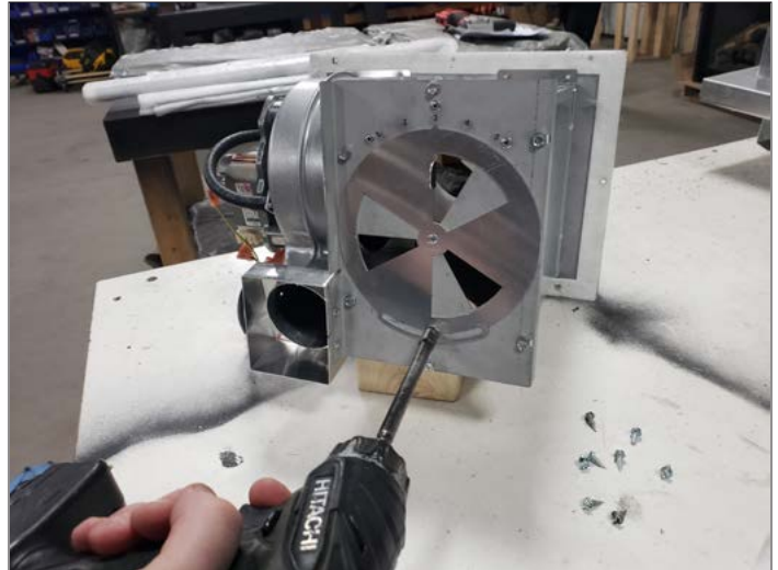
Figure 2.6, Desserrage de la vis de blocage
