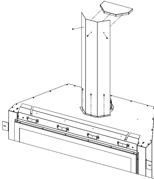
**Figure 43: Vent Shields**
