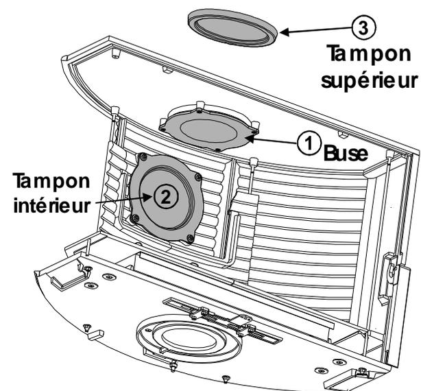
L'orientation de la buse est en position verticale en sortie d'usine.
