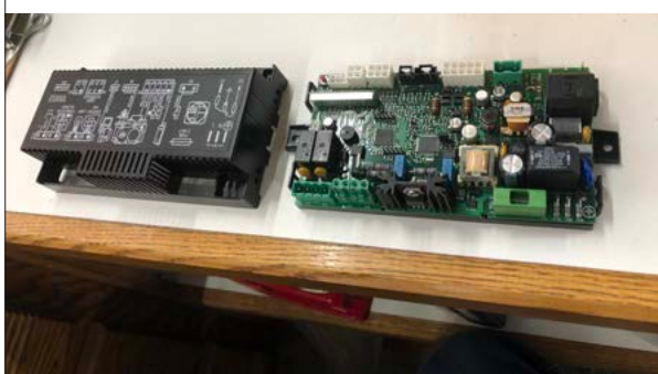
Figure 4.1, Retrait du couvercle du panneau de contrôle
