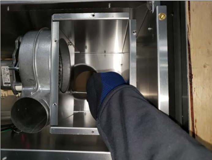
Figure 5.6, Retrait des (3) vis de fixation du ventilateur
