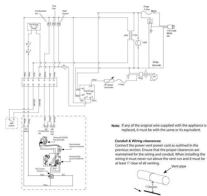
Figure 16. R520\* HSI Wiring Diagram
