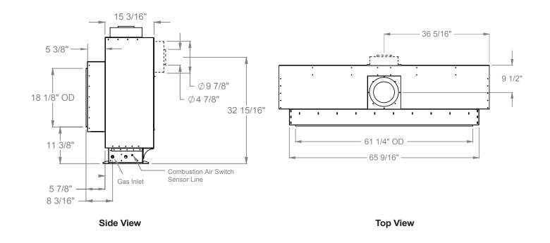
Figure 1. R520\* Fireplace dimensions (Tolerance  $\pm$  1/8").
